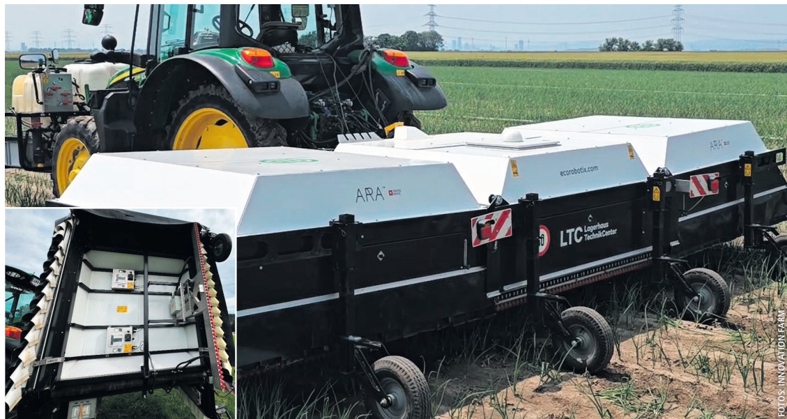
Die ARA-Spritze mit drei Modulen (Details siehe Foto unten links) und zwei Fronttanks im Feldeinsatz.
