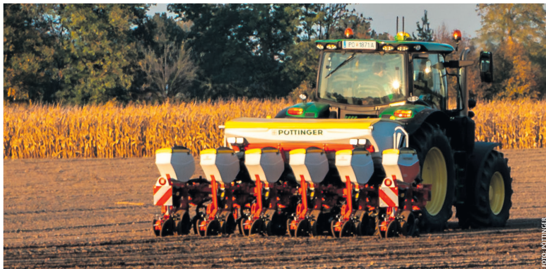
Die Puro H 3000 hat eine Arbeitsbreite von 4,5 Metern, die Reihenweite beträgt 75 Zentimeter.
