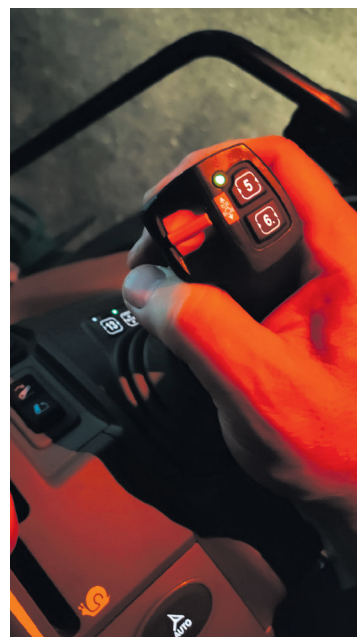
Der gesicherte Hebel nimmt erst nach Umfassen Befehle an.
