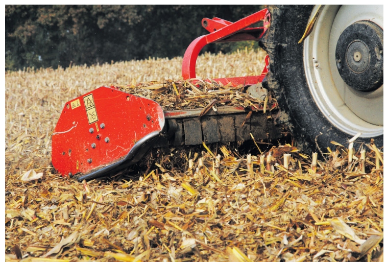
Mulcher ohne Gegenschneide liefern kein perfektes Ergebnis.
