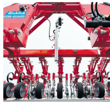
Der Rahmen hat einen Verschiebeweg von insgesamt 380 Millimetern.
