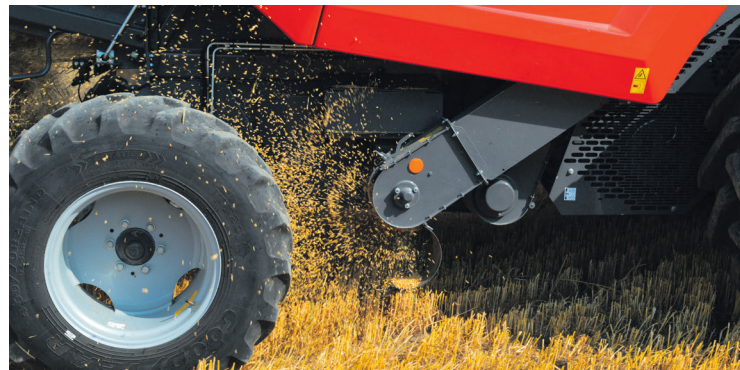
Ein zu hoher Anteil ausgedroschener Körner in der Überkehr durch falsche Reinigungseinstellungen erhöht den Bruchkornanteil in der Ernteware.
