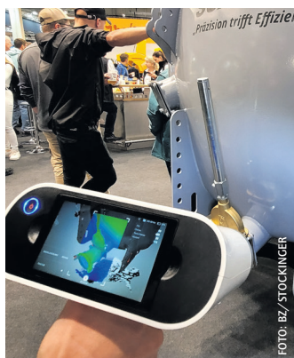
Für passgenauen Anbau wird das Fass gescannt.
