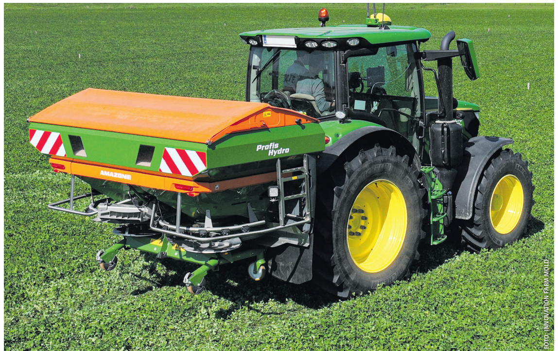
Auf den Versuchsflächen kam der Anbaustreuer ZA-TS mit NPK-Dünger zum Einsatz.
