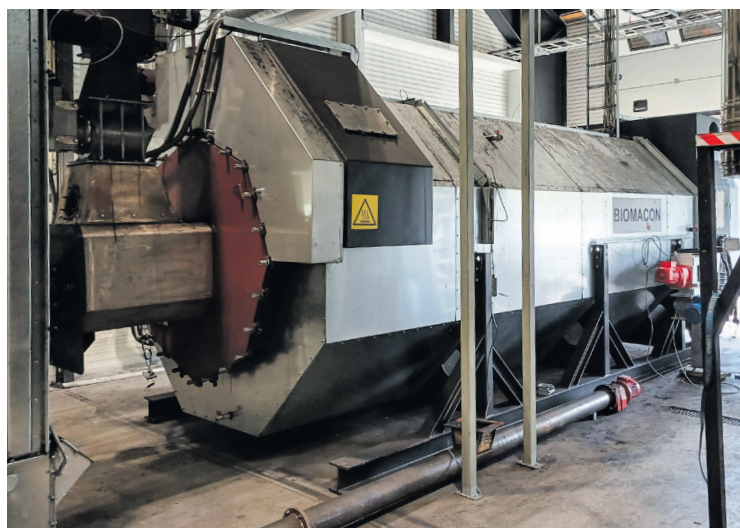
Herzstück der Produktion ist der Bioreaktor. Dort erfolgt die Pyrolyse.
