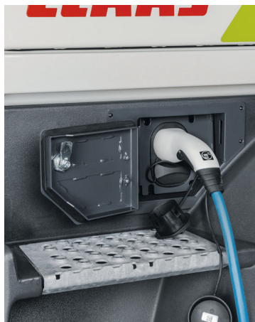
Das integrierte Onboard-Ladesystem erleichtert die Stromspeicherung.
