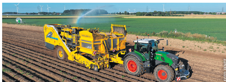
Load-Sensing zwischen Traktor und Roder: elektronisch statt hydraulisch
