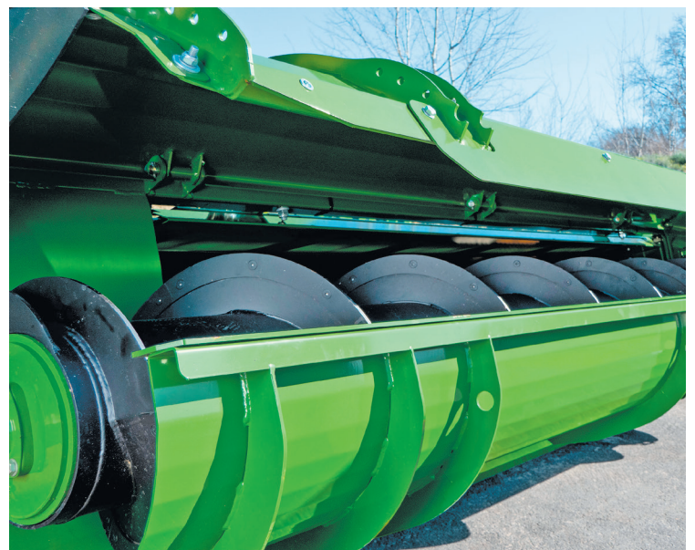
Krone Schwadablage mit Schnecke seit mehr als 25 Jahren im Selbstfahrmäher Big M bewährt. Findet jetzt optional Anwendung in allen Krone Mähwerken.
