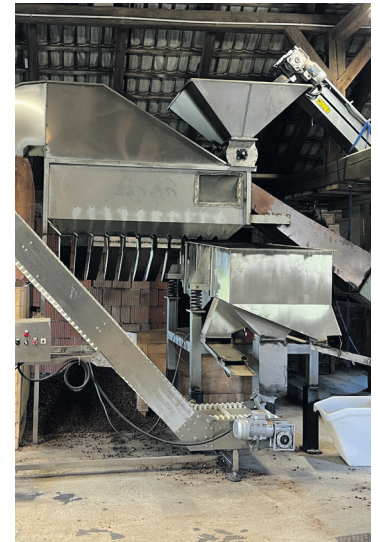
Für das Knacken der Nüsse wurde eine französische Anlage umgebaut.
