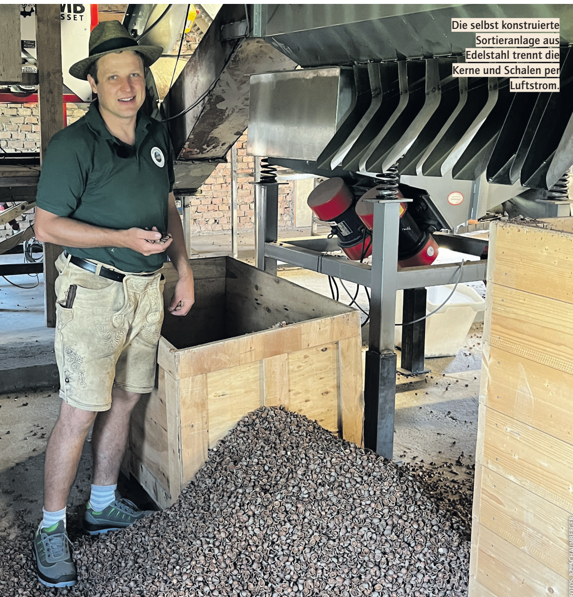
Für das Knacken der Nüsse wurde eine französische Anlage umgebaut.
