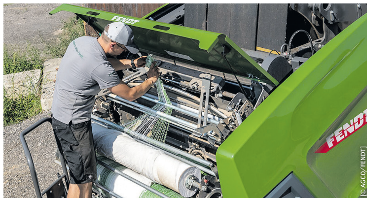
Mit der neuen Option kann der Wechsel zwischen Netz- und Folienrollen direkt aus der Traktorkabine erfolgen.
