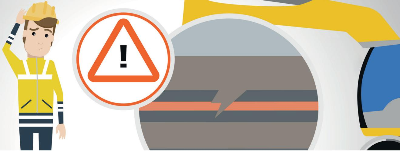
Bei jeglicher Art von Beschädigung unserer Versorgungsleitungen sind die Arbeiten sofort einzustellen, die Arbeitsstelle ist zu räumen und die Gefahrenstelle entsprechend abzusichern.
