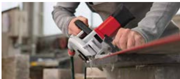
Stufenlose Winkeleinstellung für Gehrungsschnitte von 0-45°
