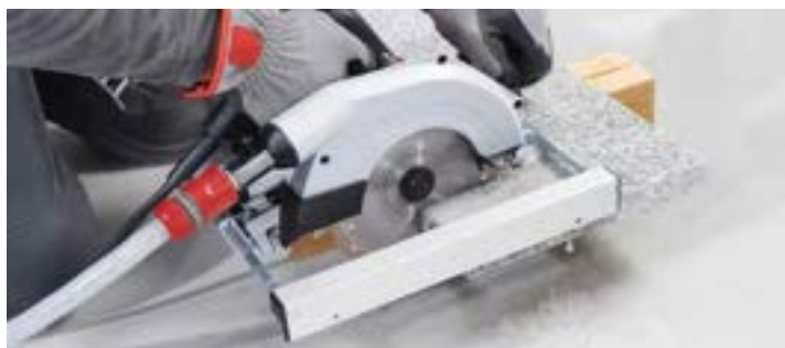
Hochleistungsmotor: extra stark zum Steinschneiden und Fugenfräsen
