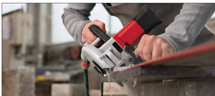
Bezstopniowa regulacja kąta dla cięć ukośnych w zakresie od 0 do 45°
