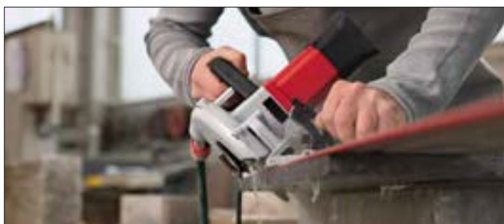
Stufenlose Winkeleinstellung für Gehrungsschnitte von 0-45°
