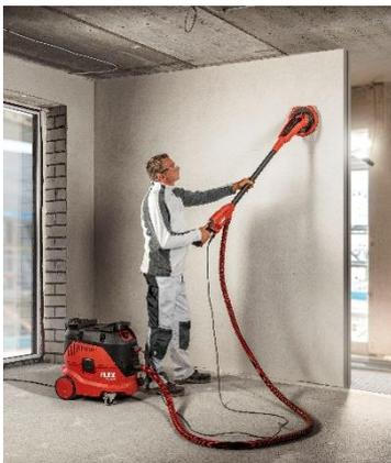
*La GE 6 R-EC dispose d'un segment de bord pratique aplati sur la tête de ponçage ainsi que d'une plage de pivotement de la tête de 160 degrés.*
