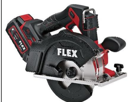
*Grâce au rail de guidage, à la butée parallèle et à la lame de scie de 150 mm, la CSM 57 18-EC permet des coupes précises et répétibles, même dans l'acier inoxydable, avec une profondeur de coupe allant jusqu'à 57 mm.*
