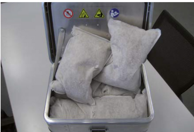
Matériau de rembourrage, par ex. vermiculite
