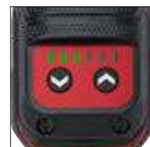
Réglage de la vitesse par des touches (uniquement pour les modèles à vitesse de rotation variable)
