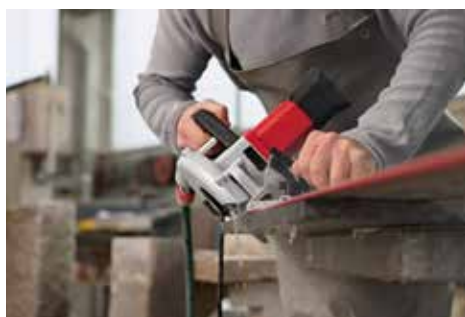
Regolazione in continuo dell'angolo per tagli obliqui di 0-45°
