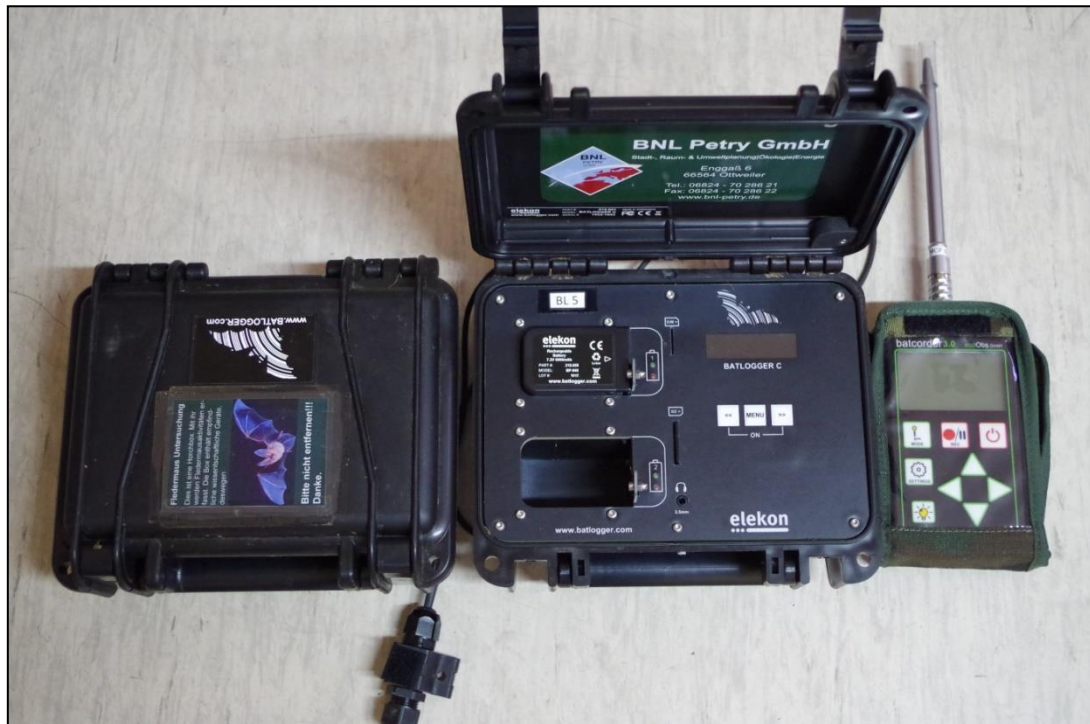
Abbildung 3 Zur automatischen Erfassung eingesetzte Horchboxen 7
