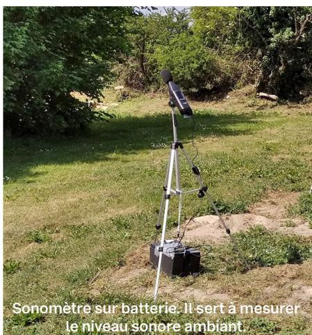
Sonomètre sur batterie. Il sert à mesurer le niveau sonore ambiant.
