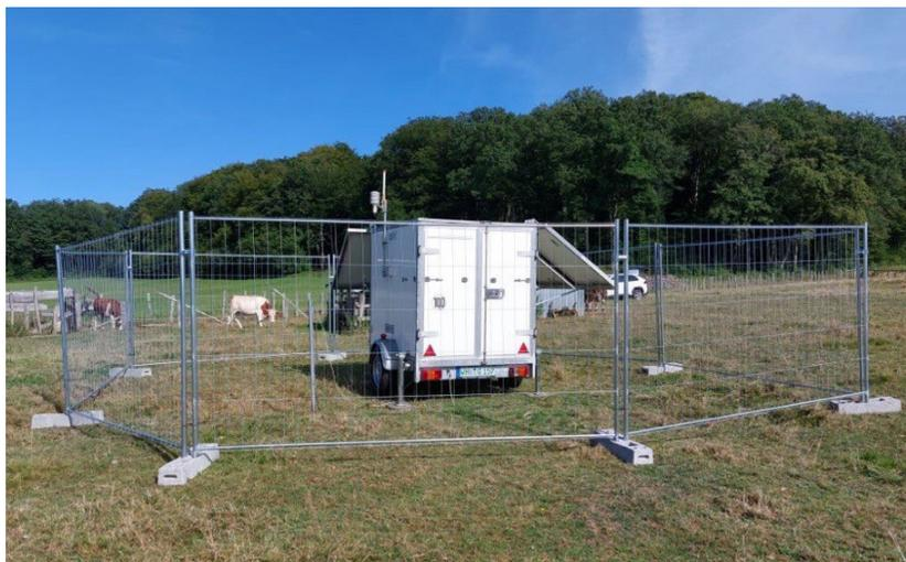
Un LIDAR est un **système de mesure** qui permet, par l'envoi d'un faisceau lumineux, de déterminer la vitesse du vent à différentes altitudes. Pour cela, le détecteur analyse la façon dont l'onde lumineuse se réfléchit sur les particules d'aérosols en suspension dans l'air.
