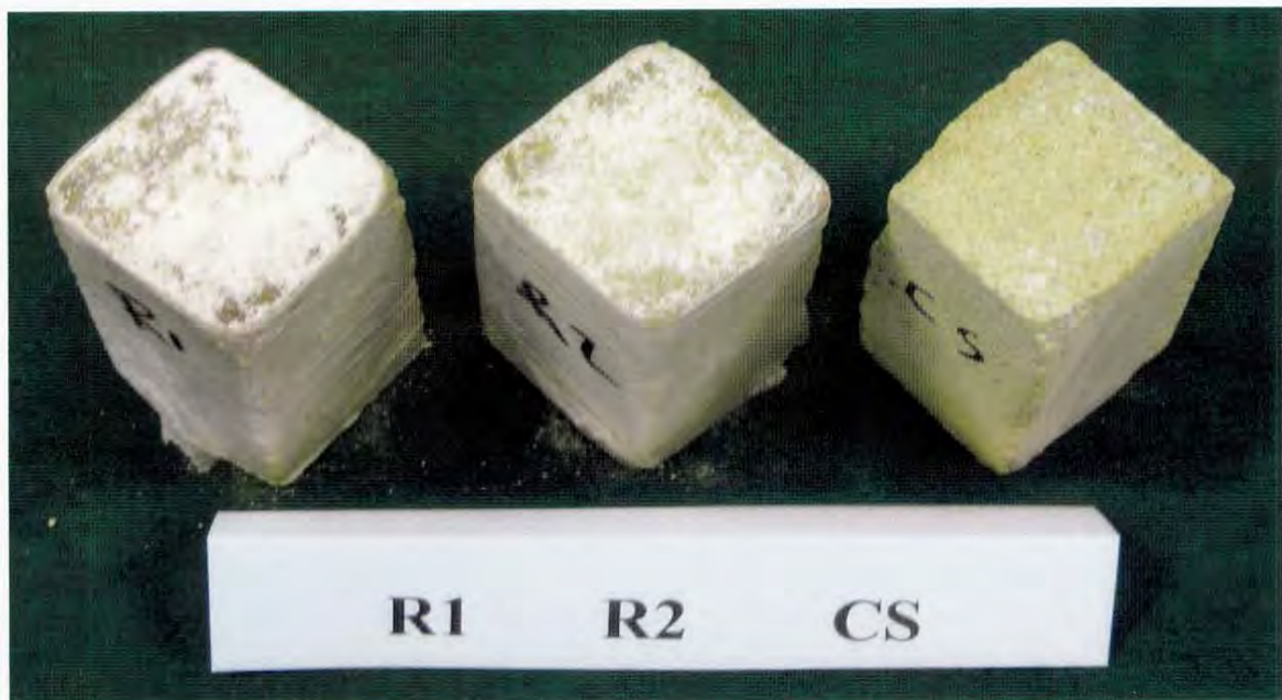
Foto 1: Onbehandelde proefstukken links en behandelde rechts, na zoutimpregnatie en droging
