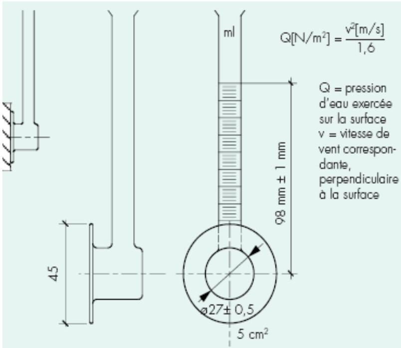
La méthode de mesure est inspirée des recommandations de la RILEM (Réunion Internationale des Laboratoires d'Essais sur les Matériaux), TC - 25 PEM – II.2.
