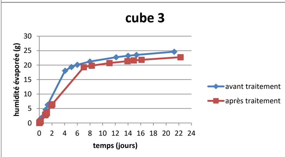
Diminution de la vitesse de séchage lors de la première phase de séchage : 21 %
