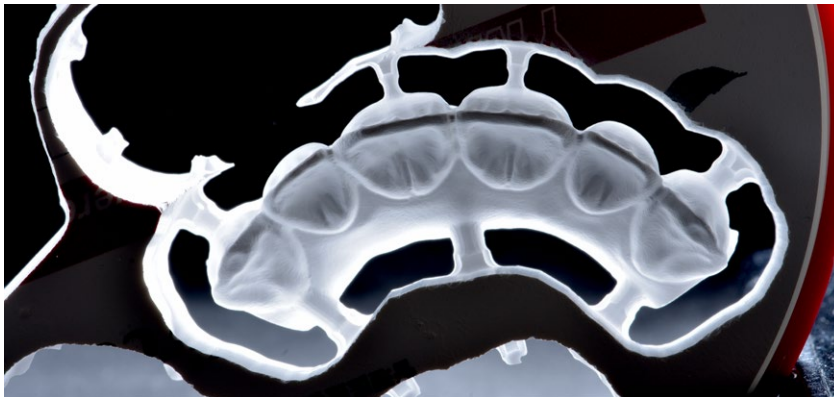
Fig. 1 : restauration usinée au sein du disque de zircone.
