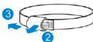
2. Führen Sie die beiden Schellen durch die entsprechenden Öffnungen der Haupthalterung und führen Sie sie um die gewählte Stange herum. Führen Sie das lose Ende der Schelle wieder bei der Klemme ein und fixieren Sie diese dann erneut mit einem Schraubenzieher, bis die richtige Feststellposition erreicht wurde.
