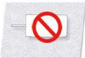
Installieren Sie das Gerät nicht horizontal.
