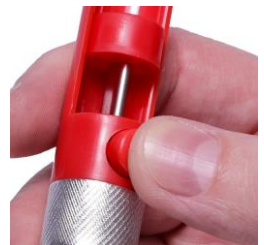
Geschmolzenes Lötzinn durch Knopfdruck aufsaugen
