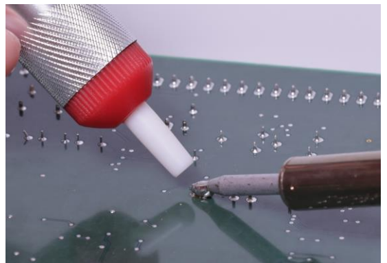
Geschmolzenes Lötzinn durch Knopfdruck aufsaugen
