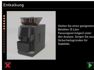
Figura: Posizionamento del recipiente sotto all'erogatore
