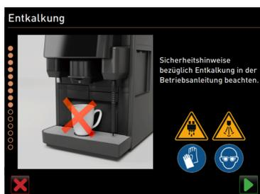
Figura: Avviamento della procedura di decalcificazione
