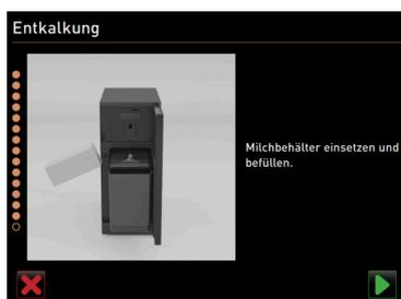
Figura: Inserimento del contenitore del latte.
