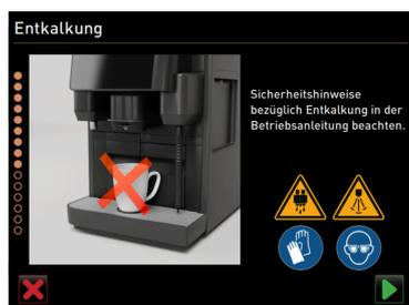
Figura: Avviamento della procedura di decalcificazione
