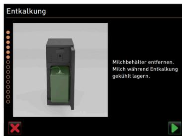
Figura: Rimozione del contenitore del latte
