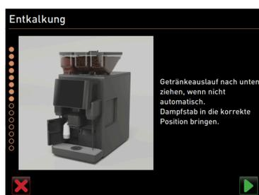
Figura: Posizionamento dell'erogatore di bevande e della lancia per vapore
