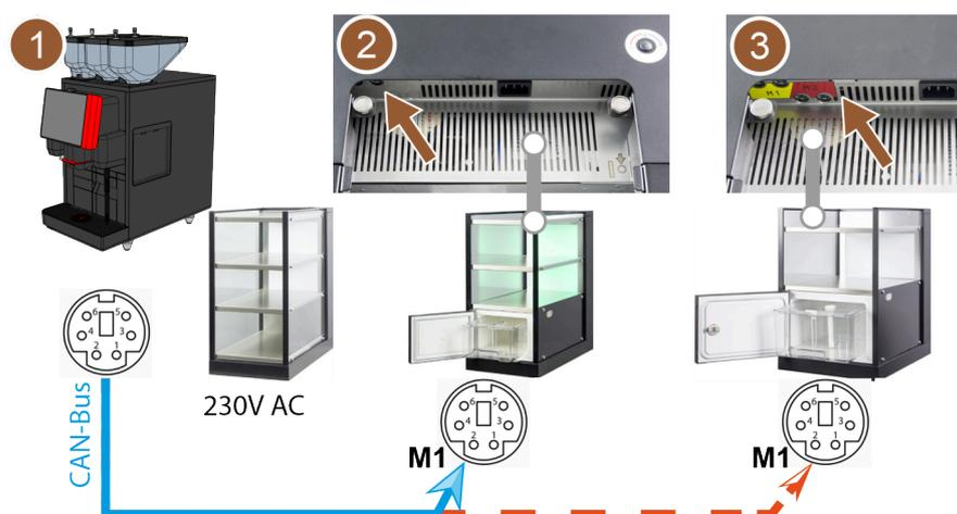
Figura: Panoramica delle connessioni CAN bus dalla macchina da caffè agli apparecchi ausiliari
