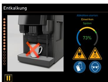
Figura: Visualizzazione dell'avanzamento della procedura di decalcificazione
