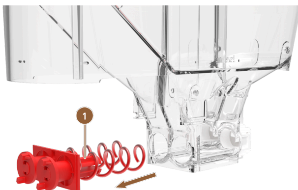
Figur: Twin-pulverbeholder: Fjern fremføringsenhed
