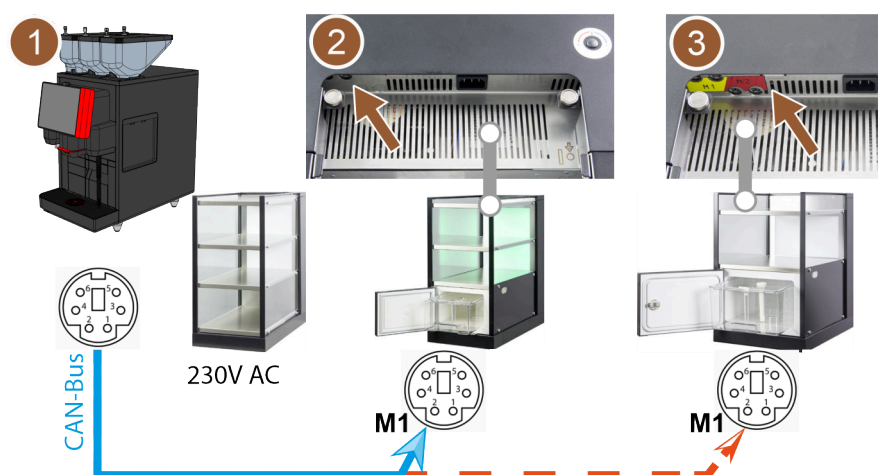
Joon.: Ülevaade kohvimasinast lisaseadmeteni viivatest CAN-siini ühendustest
