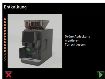
図: 保護キャップの取り付け
