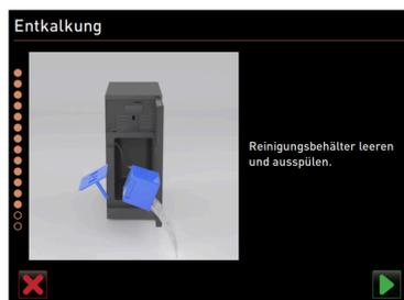
Рисунок: Извлечение контейнера для очистки
