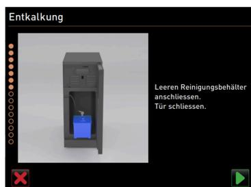
Рисунок: Установка контейнера для очистки
