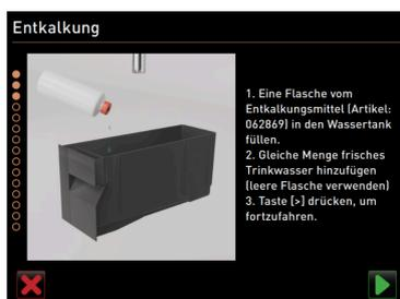
Рисунок: Заполнение жидким средством для удаления накипи
