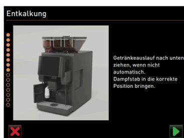
Рисунок: Позиционирование раздаточной головки и паровой трубки
