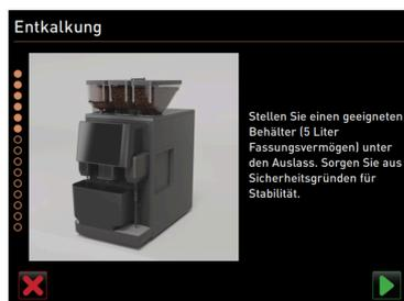
Рисунок: Размещение емкости под раздаточной головкой
