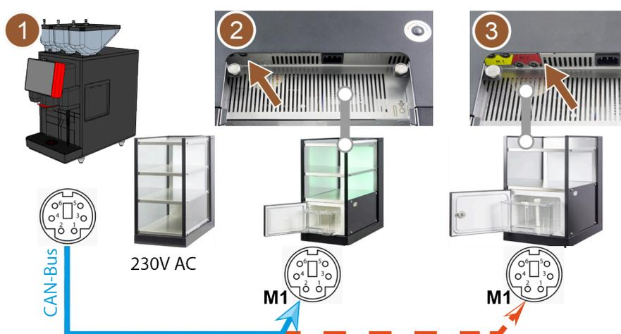
Рисунок: Обзор соединений кофемашины и приставных устройств посредством шины CAN
