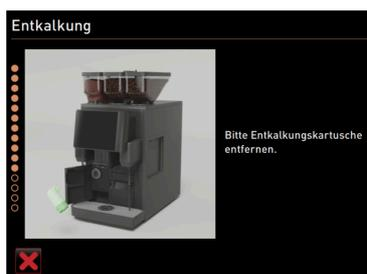
Рисунок: Извлечение картриджа для удаления накипи
