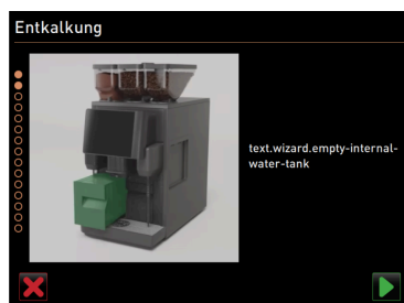
Obrázek: Vyprázdnění interní nádrže na vodu
