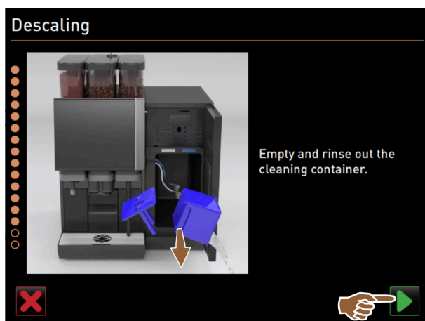
Фигура: Отстраняване и изпразване на контейнера за почистване
