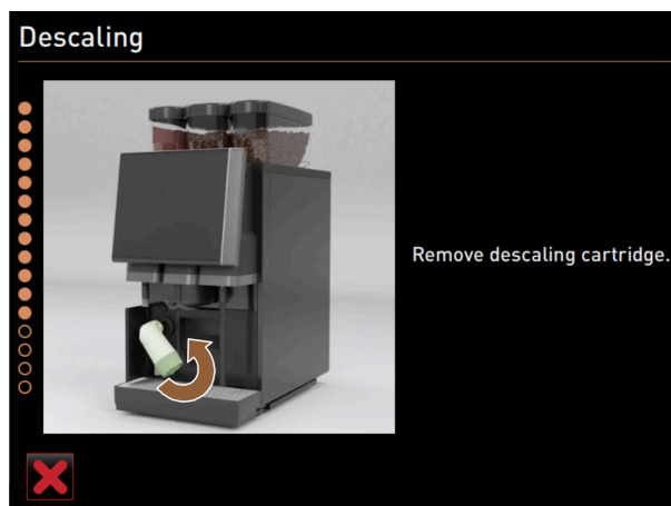
Фигура: Отстраняване на касетата за премахване на котлен камък
