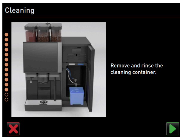
Фигура: Отстраняване на контейнера за почистване
