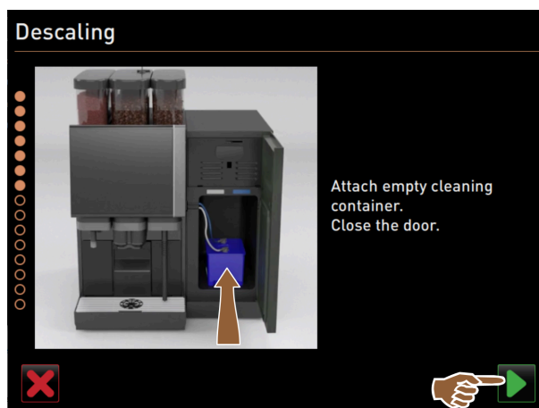
Фигура: Поставяне на контейнер за почистване
