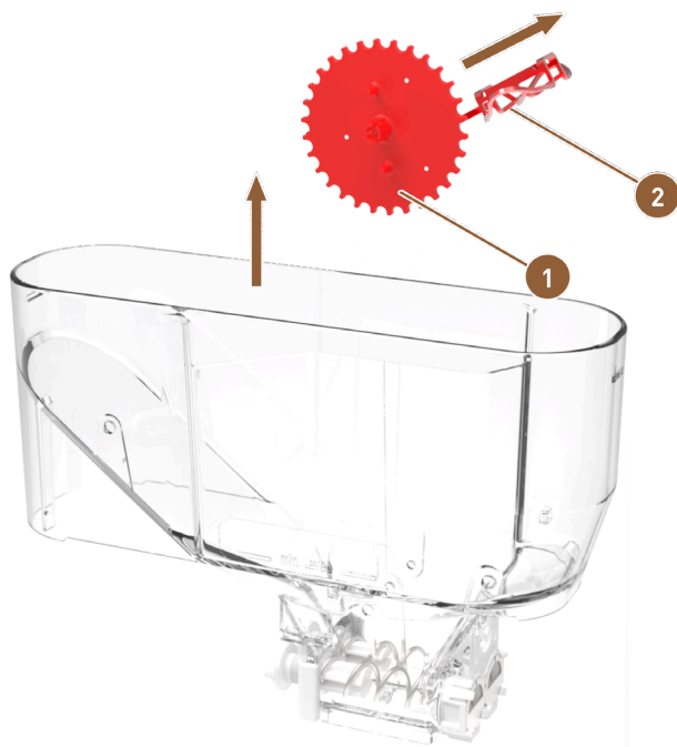
Фигура: Twin контейнер за прахообразни продукти: Отстраняване на разрохкването на прахообразния продукт
