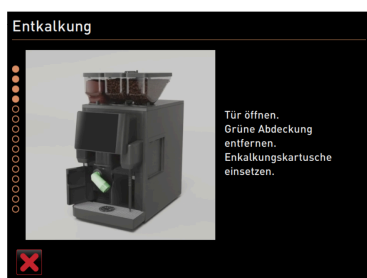
Figura: Introducerea cartușului de decalcifiere
