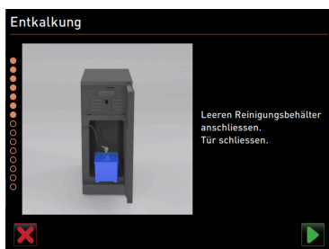
Figura: Introducerea recipientului de curățare
