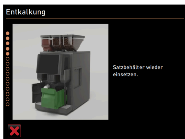
Figura: Introducerea recipientului pentru zaț pentru zaț
