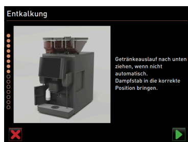
Figura: Poziționarea evacuării pentru băuturi și a baghetei pentru abur
