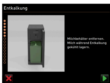
Figura: Înlăturarea recipientului pentru lapte
