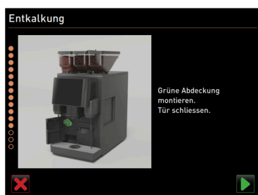
Figura: Așezarea căpăcelului de protecție
