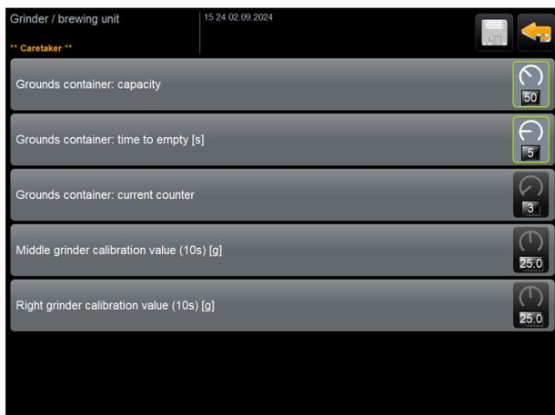
Abb.: Bildschirm mit Einstellungen für Mühle/Brüheinheit
