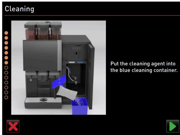
Abb.: Reinigungsmittel in Reinigungsbehälter geben
