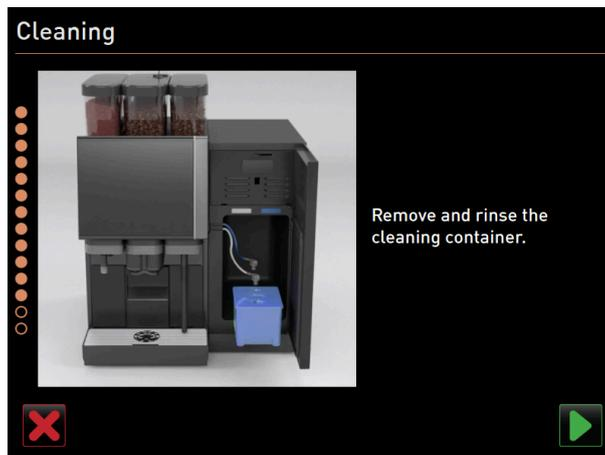
Abb.: Reinigungsbehälter entfernen
