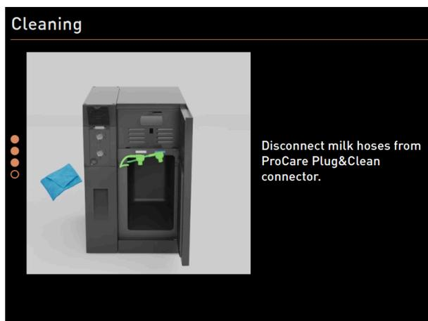
Abb.: Milchschräume von **Plug&Clean**-Anschlüssen entfernen
