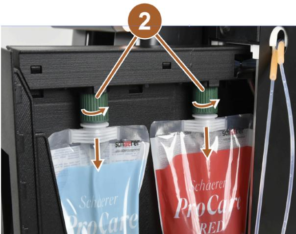
Abb.: Reinigungsbeutel entfernen
