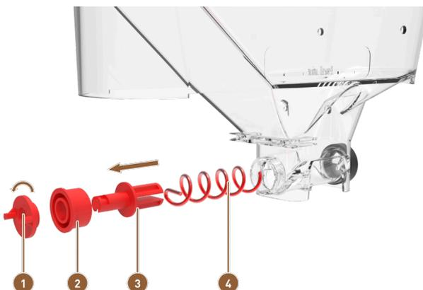
Abb.: Standard-Pulverbehälter: Fördereinheit zerlegen
