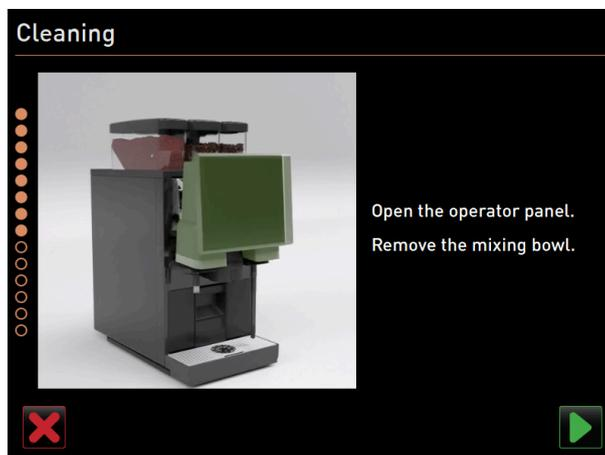
Abb.: Bedienpaneel anheben
