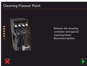
1. Reinigungsbehälter und Reinigungsschläuche entfernen.
