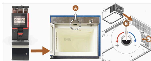
Bild: Slå på och ställ in undermonterad kylvagn
