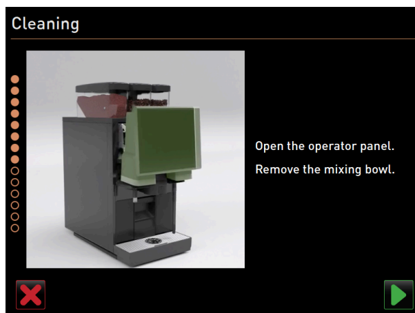
Bild: Lyft upp kontrollpanelen
