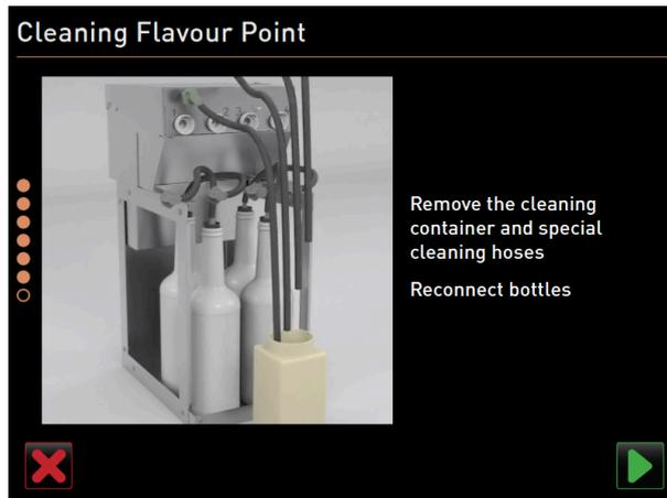
Fig.: Extraer de nuevo el depósito de limpieza
