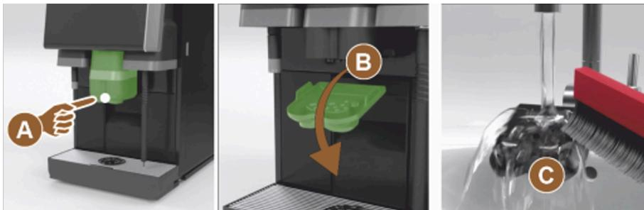
Fig.: Extracción de la parte inferior de la cubierta de la salida de bebida
