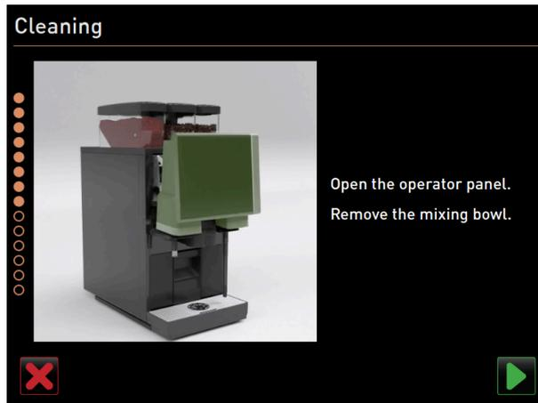
Fig.: Retirada del panel de operación
