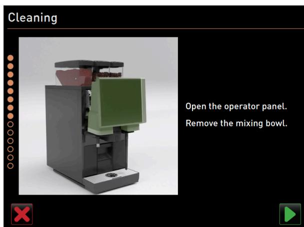
Fig.: Retirada del panel de operación
