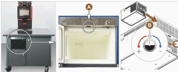
Fig.: Encender y ajustar la unidad refrigeradora bajo mostrador
