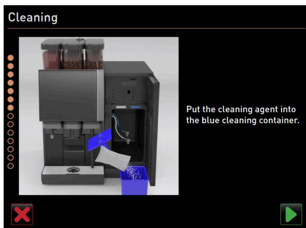
Fig.: Introducir el producto de limpieza en el depósito de limpieza
