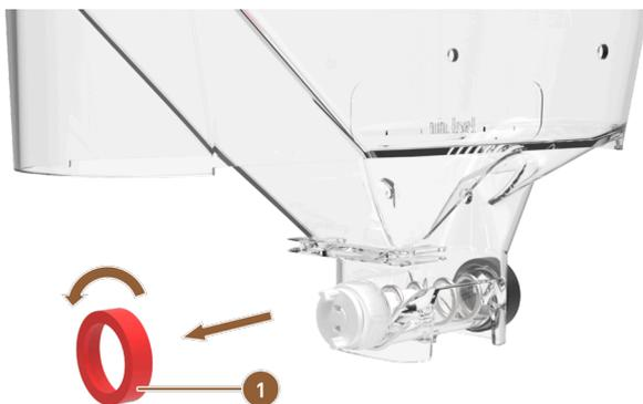
Fig.: Depósito de polvo estándar: Retirar tuerca de unión en lado de transporte
