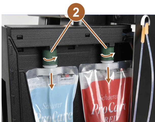
Fig.: Retirada de las bolsas de limpieza
