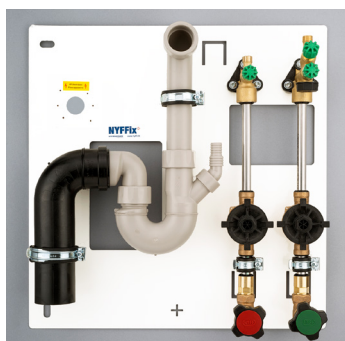
7900 L/R – mit Wasserzählern und Absperrventilen – Dimension 1/2" IG NPK / Suissetec 222.817
