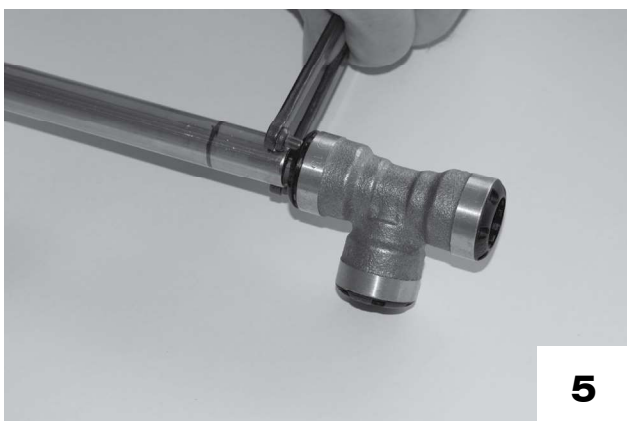
Fitting kann ab dem Rohr gezogen werden.
