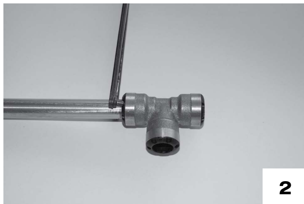
Kunststoffhülse mit Schlüssel im Gegenuhrzeigersinn lösen.
