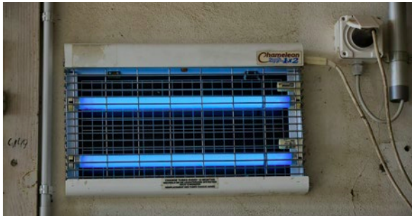
Un désinsectiseur à UV pour la lutte contre la pyrale.
