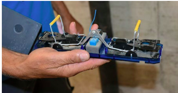
Un piège mécanique pour les rongeurs, équipé d'un émetteur.
