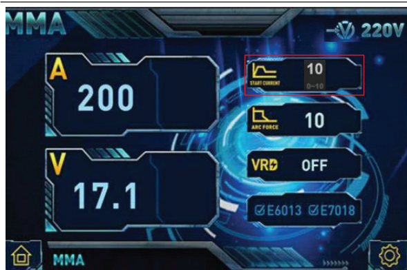
Démarrage à chaud 0-10
