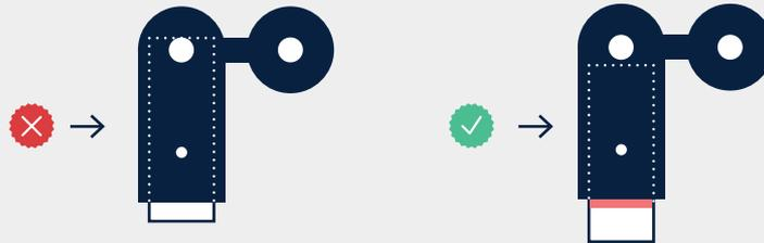
**B** Entfernen Sie noch nicht die Schutzfolie auf der Rückseite.
