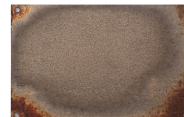
Thép mạ nhôm kẽm thông thường (AZ) Conventional Al-Zn alloy coated steel (AZ)
