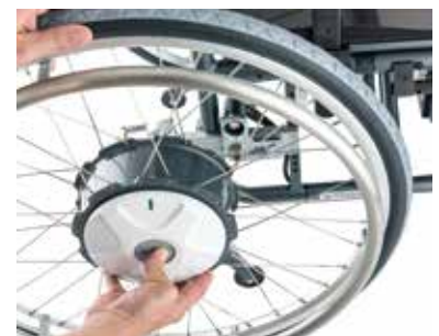
Abnehmen der Antriebsräder per Schnellentriegelung
